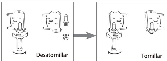
6. Instale la bisagra en el lado izquierdo y la base del pie en el lado derecho, luego atornille dos pies ajustables con sus partes originales.
