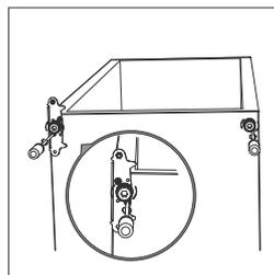
7. Desatornille el eje de la bisagra superior y móntelo en el orificio izquierdo.
