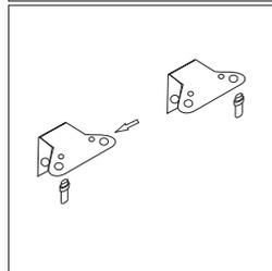
8. Levante la unidad y coloque la puerta en la bisagra inferior. Asegúrese de que el centro de la bisagra inferior esté insertado en el orificio de la puerta. Luego coloque la bisagra superior con la puerta. Antes de fijar firmemente la bisagra superior, intente abrir la puerta para verificar si está bien sellado. Finalmente, atornille la tapa de la bisagra con la bisagra.
