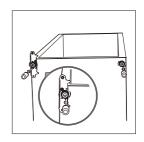
9 Invierta la bisagra del medio en 180 grados, luego trasládela a la posición izquierda adecuada. Ajuste la bisagra en el agujero superior de la puerta inferior, fíjela con tornillos.
