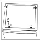
Desatornille los tornillos que se utilizan para sujetar la bisagra superior derecha.
