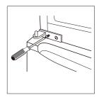
10. Vuelva a colocar la puerta superior. Asegúrese que la puerta está alineada horizontalmente y verticalmente, así para que las juntas se cierren en ambos lados antes de colocar la bisagra superior. Luego inserte la bisagra y desenrollelo hacia la parte superior de la unidad.
