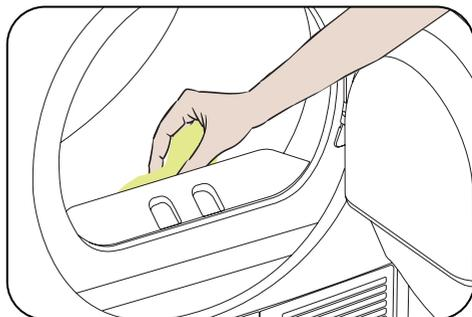
En el interior de la máquina hay sensores de humedad que detectan si la colada está seca o no.
