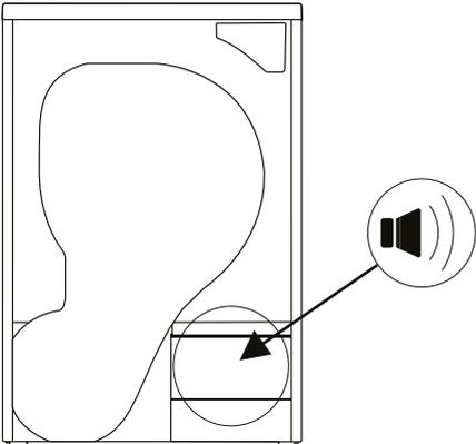
A line drawing of a washing machine drum. A circular area at the bottom right is circled, with an arrow pointing to a speaker icon. The speaker icon is a black trapezoid with three curved lines to its right, indicating sound.           | <p><b>Sonido de la bomba</b></p> <p>La bomba se activa cuando la máquina empieza a funcionar y durante el funcionamiento a determinados intervalos. Es normal escuchar el sonido de la bomba y del agua durante este proceso.</p> |
